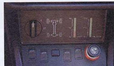
De differentiëlen zijn te blokkeren.
